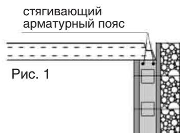
При использовании монолитной конструкции (рис. 2) блоки бетонируются на уровне нижней плоскости потолка. На бетонном каркасе устанавливается стягивающий арматурный пояс.
